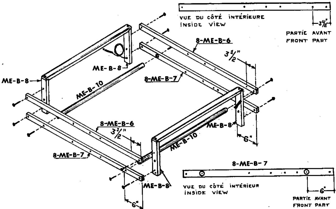
Vissez la traverse 8-MB-7, la partie de la traverse qui a 6" de distance entre le trou pour la traverse ronde et le bout de la traverse, au montant MB-8, c'est-à-dire celui qui porte les cliquets, donc à l'avant du métier.
