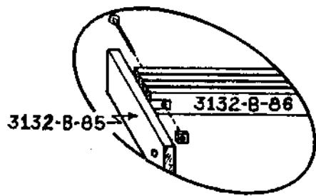
Placer le métier sur la base et fixer ce dernier à l'aide de boulons de 5/16" x 2" et écrous-papillons.
