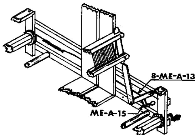
Accrochez la longue broche tire-frein au ressort, levez le levier à frein MA-15 et accrochez l'autre bout de la broche au rivet du levier à frein. Remettez le levier en place.
