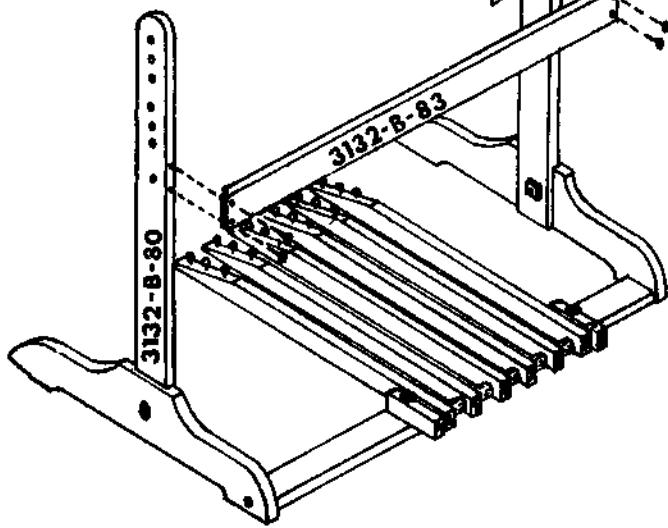
Fixer les contremarches dans le support 3132-B-85 avec un boulon à machine de  $\frac{1}{4}$ " x 3" et écrou carré  $\frac{1}{4}$ ". Fixer le support 3132-B-85 dans le dernier trou du montant gauche 3132-B-80 (vis-à-vis la traverse 3132-B-83) à l'aide d'un boulon à voiture 5/16" x 2" et écrou carré 5/16".
