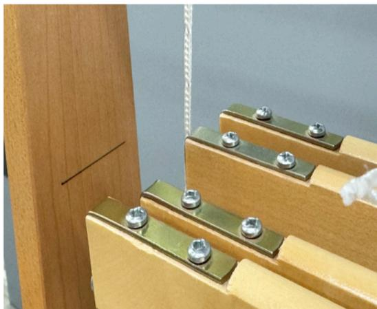
Avec une tension normale sur les fils de chaînes une ouverture plein ros est possible.
