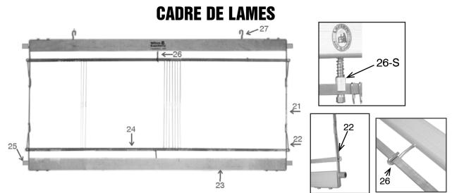
Les cadres de lames pour les Dorothy 15¾" et 24" sont en métal.Les cadres de lames des métiers Compact 24" sont de bois avec des supports d'aiguilles en métal.Les cadres de lames des autres métiers sont de bois (haut et bas) et métal (bout et support aiguilles).
