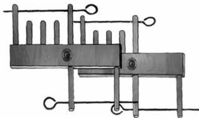
Sert à la fois de stabilisateur de cadres et de support pour les baguettes d'encroix, gardant ainsi la croisée à la hauteur pratique pendant le passage en lames.
