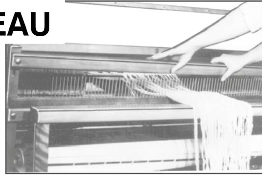
Pour étendre la chaîne lors du pliage ou l'enroulage de la pièce. L'opération se fait rapidement parce que le dessus du peigne est ouvert pour recevoir les fils de chaîne et est ensuite recouvert par le chapeau du battant. (8 espaces par 10 cm ou 2")
