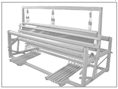
Un métier 4 cadres, contre-balancé, pour le tissage large tel que couvertures, draperies, tapis, etc. Élargi à 49" (125 cm) de profond, il donne une ouverture parfaite. Il est le métier le plus souple de cette largeur sur le marché.Il doit être opéré par deux tisserands, chacun ayant son pédalier, permettant de lancer et de recevoir la navette à tour de rôle.Le système de frein est très solide avec 2 gros câbles d'acier
