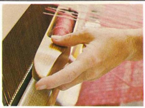
28. La navette est introduite dans le pas et lancée d'une main pour être attrapée de l'autre côté avec l'autre main.
