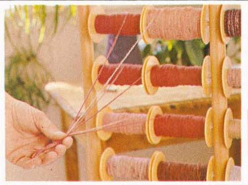
5. Les six bobines sont placées sur un cantre dans l'ordre des couleurs. La boîte à tension est fixée sur le porte-fils.
