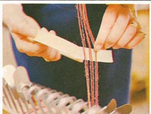
10. À la fin de l'enroulement de chaque section, les fils sont collés à plat sur un ruban gommé, l'ordre des couleurs étant conservé. Ils sont coupés au-dessus du ruban et fixés sur la partie enroulée.
