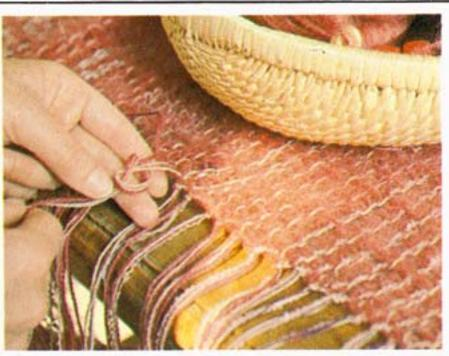
32. Les fils de chaîne, noués par groupes, et un léger pressage à la pattemouille constituent les éléments d'une finition impeccable.
