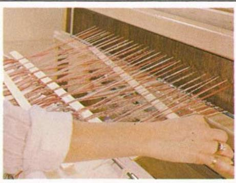
26. La tirelle permet l'obtention d'une nappe uniforme de fils en début de tissage. Elle s'obtient en insérant des baguettes dans la foule par une ouverture-toile.
