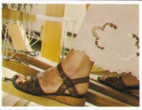
25. La pression sur une pédale produit l'ouverture de la chaîne, appelée aussi le pas ou la foule.
