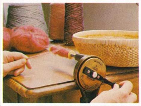
27. Le fil utilisé pour tisser s'appelle la trame. Il est enroulé sur une petite bobine qui est placée dans la navette.
